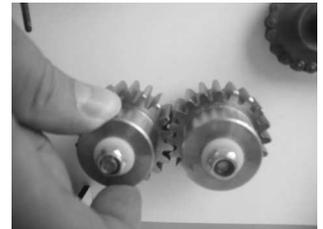
b. À l'aide d'une clé plate N° 8 desserres l'écrou de fixation de la roue dentée située du côté droit. Déplaces le plus possible la roue dentée vers la gauche. Serres l'écrou pour fixer à nouveau la roue dentée.
