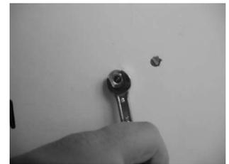
c. À l'aide d'une clé plate N° 8 desserres à nouveau l'écrou de fixation de la roue dentée située du côté droit. Cette fois-ci, déplaces le plus possible la roue dentée vers la droite. Serre l'écrou pour fixer à nouveau la roue dentée.
