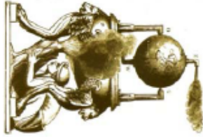
Eolipyle ou boule d'Eole, décrite par Héron d'Alexandrie (200 avant J.C.)
