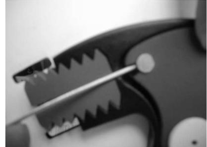
Fixer le **câble** dans la rainure de l'**écrou de réglage**
