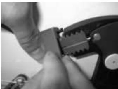
Déclipser le **contre écrou** en pinçant ses 2 pattes
